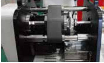
모터를 이용하여 구동하는 방식으로 내부에 스크류를 설치하여 플런저가 왕복 운동 하여 압력을 발생시킴
