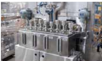
비가동시 원료의 고형화방지를 위한 용액 저장 탱크 및 자동 밸브 장착
