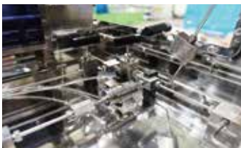
Back Flushing System으로 챔버(Chamber) 막힘 현상 발생 시 편리하게 세척 가능
