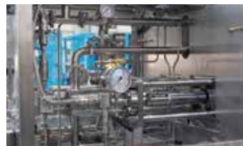
내부 셀 수명을 위해 고압 발생 부분에 냉각라인을 설치하여 마찰에 의한 손상 최소화
