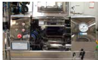
시료 주입부를 제외한 배관 라인에 외부 케이스를 설치하여 안전성 확보
