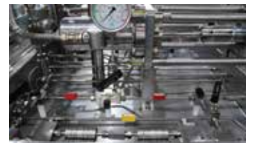
Back Flushing System으로 챔버(Chamber)의 막힘 현상 발생 시 편리한 세척 가능
