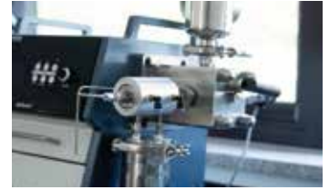
공정 후 배출되는 시료의 냉각을 위해 냉각 장치 장착 가능
