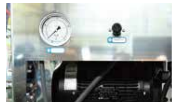
유압 유닛을 이용하여 챔버(Chamber) 내 압력 조정
